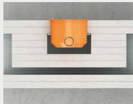
Montážní stěna bez izolace pro protipožární ochranu – zásuvky, krabice vypínačů a rozdělovačů atd. musí být uvnitř dutiny stěny zakapslovaná předepsanou vrstvou a tloušťkou desek fermacell
