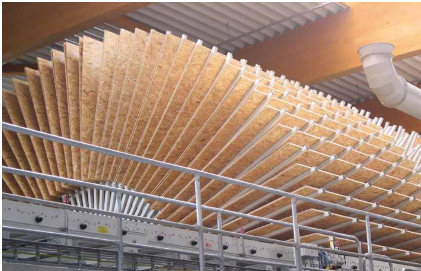
Vysoké standardy jakosti: Desky OSB jsou součástí oběžného kola chladicí jednotky v závodě EGGER.
