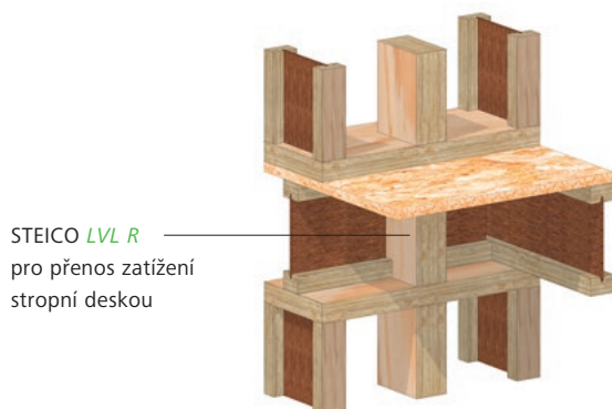
F5 Přenos vysokých bodových zatížení stropní deskou
