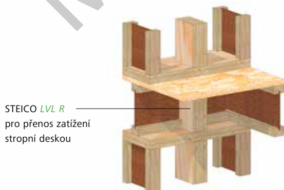
F5 Přenos vysokých bodových zatížení stropní deskou
