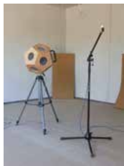
Versuchsaufbau zur Messung von Luftschallschutz
