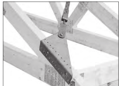
Detail am Traufpunkt: Bandanschluss BNG25 mit Spanngerät BNSP25 seitlich am Sparren mit Nägeln befestigt. Holzbreite: mind. 45 mm, max. 100 mm
