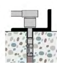
4. Apply installation torque using a calibrated torque wrench / použít momentový klíč
