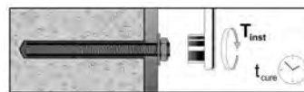
6. Secure attachment with a calibrated torque wrench (Curing time must be observed) / opatrné připevnění pomocí kalibrovaného momentového klíče (čas vytvrzení musí být dodržen)
