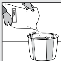
Obr. 10: Spárovací tmel fermacell se pomalu nasype do vody
