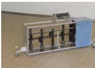
Normhammerwerk Versuchsaufbau Trittschallschutz
