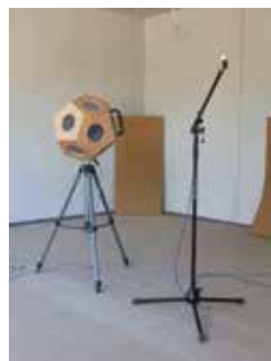
Versuchsaufbau zur Messung von Luftschallschutz
