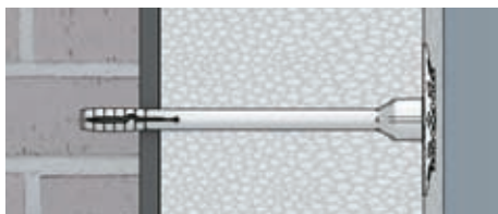
špatně: zatažení talíře je malé (nedostatečně hluboko)
