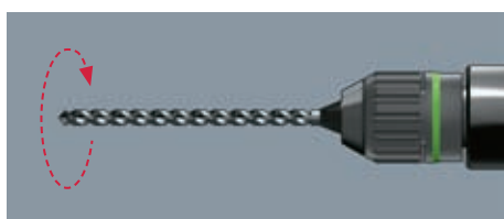
vrtání: bez přiklepu
