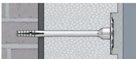
špatně: příliš hluboké zatažení talíře
